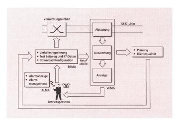
Fig. 1 Zusammenwirken der Systeme VEMA (Verkehrsdatenerfassung), BEMA (Konfigurationsmanagement) und ALMA (Alarmmanagement)
