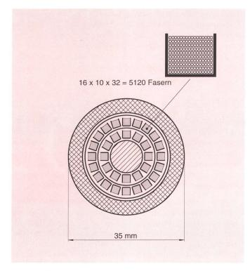
Fig. 5 Bandfaserkabel mit lagenverseilten U-förmigen Trägerelementen
