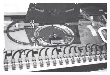
Fig. 13 Spleissung der Bandfasern auf Pigtails
