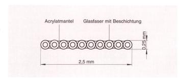
Fig. 6 Geklebte Bandfaser mit zehn Fasern
