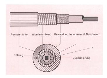
Fig. 3 Bandfaserkabel mit Zentralrohr
