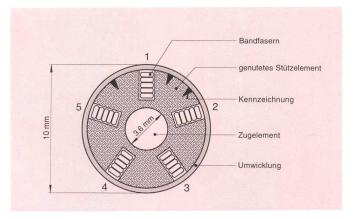
Fig. 8 Aufbau des Kabelbündels
