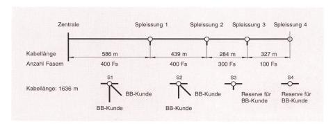
Fig. 11 Schematischer Längenplan für Projekt Zürich
