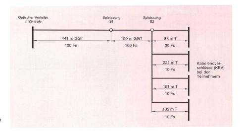
Fig. 9 Schematischer Längenplan für Projekt Basel
