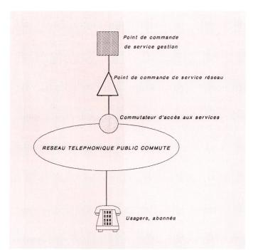
Fig. 1 Principaux composants du réseau intelligent (RI)
