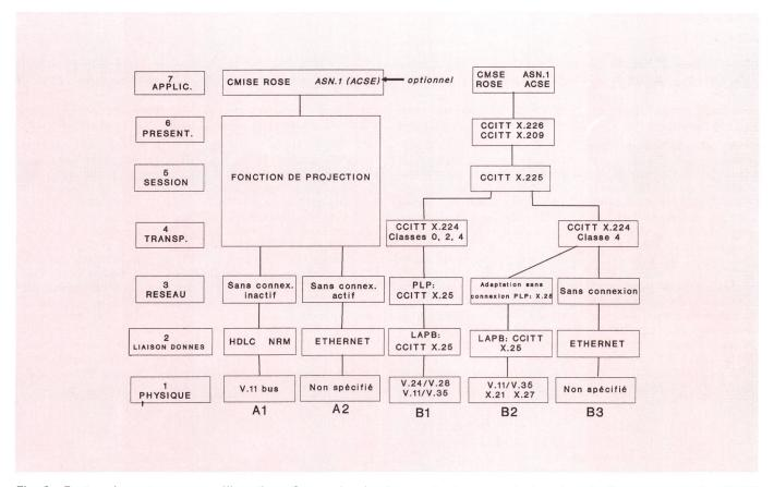
Fig. 6 Protocoles retenus pour l'interface Q pour les équipements de transmission dans la Recommandation G.733 du CCITT
