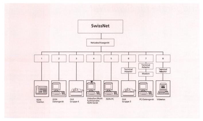
Fig. 1 Basisanschluss
