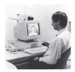
Fig. 1 Bildtelefon, in PC-Arbeitsplatz integriert, mit ATM-Schnittstelle ans Netz angeschlossen
