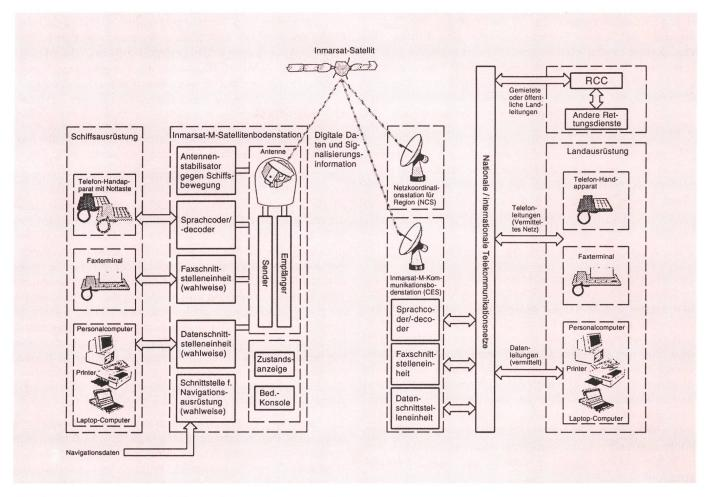
Fig. 6 Schematische Funktionsweise von Inmarsat-M NCS Network Coordination Station
