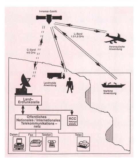
Fig. 2 Das Inmarsat-Satellitensystem RCC Rescue Coordination Centre — Rettungsleitstelle
