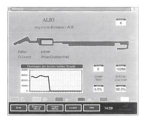
Fig. 4 Darstellung der Alarmzustände
