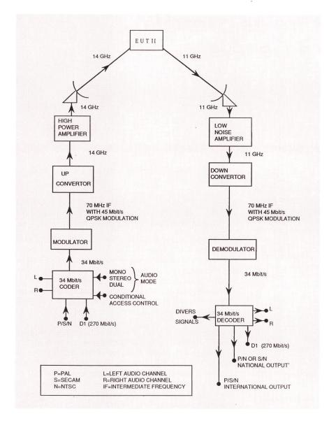
Fig. 2 Chaîne de transmission à 34 Mbit/s
