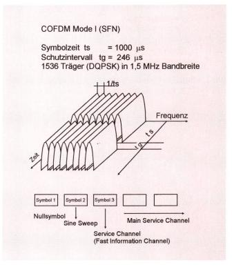
Fig. 8 Struktur des COFDM-Signals
