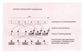
Fig. 7 Concealment (Überdeckung) von Fehlern durch zeitliche Verschachtelung
