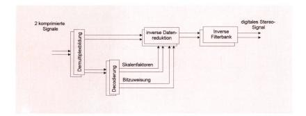
Fig. 4 Funktionsprinzip des MUSICAM-Decoders
