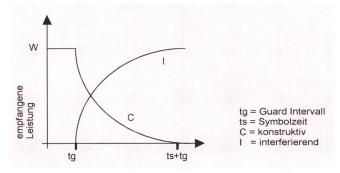
Fig. 10 Beiträge der konstruktiven (C) und interferierenden (I) Signalanteile bei Echos, die später als das Schutzintervall (tg) eintreffen. Die Zeit ts entspricht der Symbolzeit
