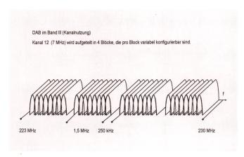
Fig. 9 Belegung eines 7-MHz-Fernsehkanals mit vier DAB-Frequenzblöcken
