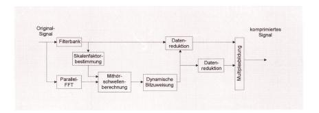
Fig. 3 Funktionsprinzip des MUSI-CAM-Coders
