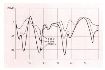
Fig. 5 Fading entlang einer Wegstrecke bei verschiedenen Bandbreiten (selektives Fading)
