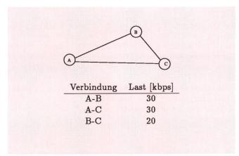
Fig. 1 Gegebene Verbindungen und deren Last tij
