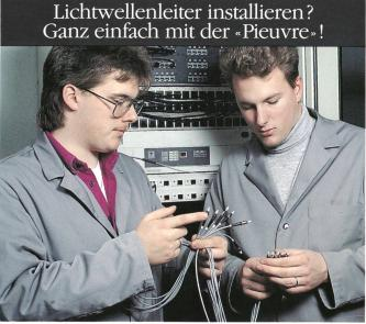
Die «Pieuvre» ist ein LWL-Installationskabel welches an beiden Enden mit werkseitig montierten Steckern ausgerüstet ist. Lieferbar sind Kabel mit 6 bis 12 Fasern und bis 500 m Länge. Für die Verlegung sind die Stecker in einem abmontierbaren Kunststoffschlauch geschützt.
