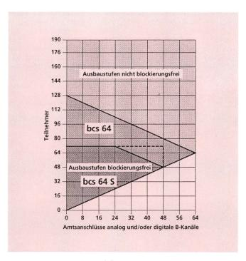
Fig. 2 Anschlusskapazität
