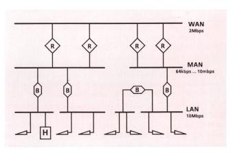
Fig. 4 Brücke (Bridge) und Router (Vermittlungseinrichtung)
