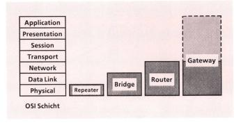
Fig. 6 Netzelemente des Infnet
