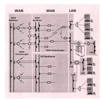
Fig. 10 Aufbauprinzip des Infnet
