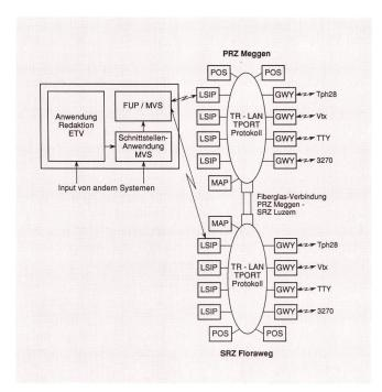
Fig. 3 Architektur des ETV-Teilsystems «Auskunft»
