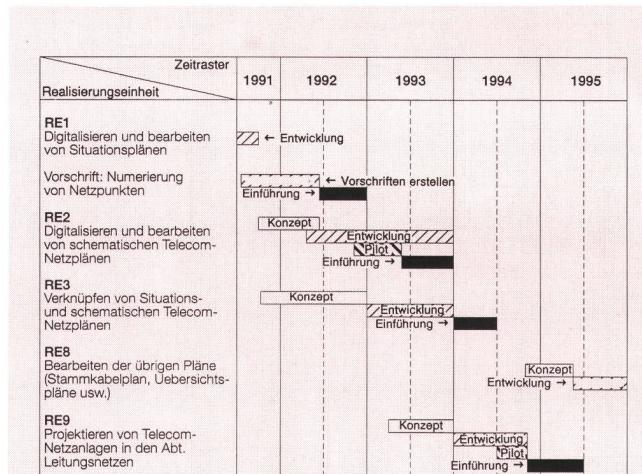
Fig. 1 Realisierungseinheiten mit direkter Schnittstelle zum schematischen Telecom-Netzplan – Développement des diverses phases de réalisation ayant un rapport direct avec les plans schématiques du réseau Télécom
