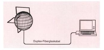
Fig. 10 Die Kugel als Sensorträger und Elektronikgehäuse
