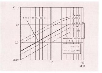
Fig. 6 Steuerung des Dipolmodes Σ durch Veränderung der symmetrischen Schleifenlasten Z (einschliesslich 7 pF Streukapazität)
