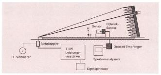
Fig. 7 Messaufbau in der GTEM-Zelle
