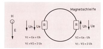
Fig. 4 Eine symmetrisch belastete Magnetschleife zeigt Summe und Differenz des elektrischen und des magnetischen Feldes an
