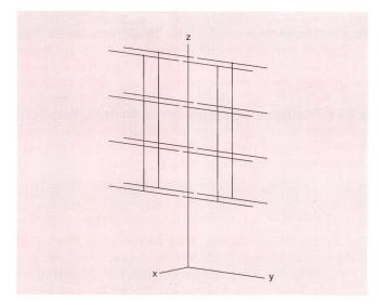
Fig. 13 Perspektivisch dargestelltes Stabmodell der analysierten Vorhangantenne, Typ HR 4/4/0,8, bestehend aus 32 horizontalen λ/2-Dipolelementen (16 Strahler, 16 Reflektoren) und den zugehörigen, jeweils gekreuzten Speiseleitungen. Die untersten Elemente befinden sich 0,8 λ über dem Boden
