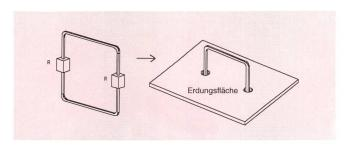
Fig. 9 Die Monopolstruktur bietet zwei Vorteile: die Sensorspannungen können unter der Erdungsfläche (Groundplane) abgegriffen werden, und das Gehäuse der Messelektronik und des Sensors bilden eine Einheit
