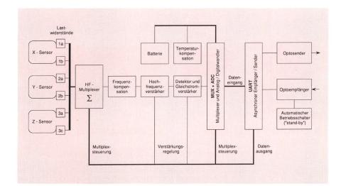
Fig. 11 Blockschema der Sensorelektronik
