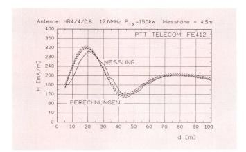
Fig. 17 Magnetische Feldstärke in Funktion des Abstands d zum Antennenzentrum Messhöhe 4.5 m
