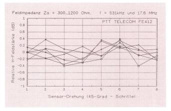
Fig. 21 Isotropie des Sensors, magnetisches Feld
