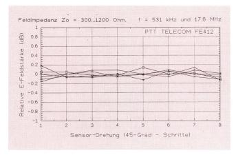
Fig. 20 Isotropie des Sensors, elektrisches Feld
