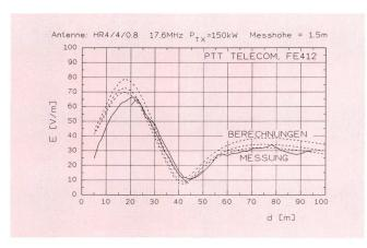
Fig. 14 Elektrische Feldstärke in Funktion der Distanz zum Antennenzentrum
