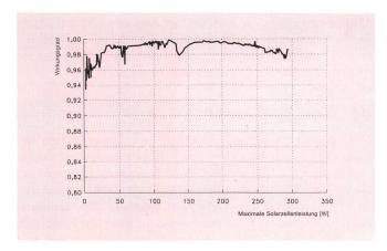
Fig. 4 «Mitlaufender» Wirkungsgrad der Laderegler (Tracking Efficiency)
