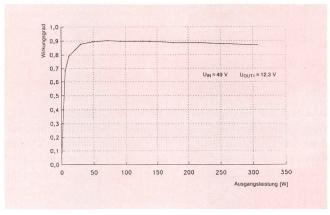
Fig. 3 Gleichstrom-zu-Gleichstrom-Wirkungsgrad der Laderegler
