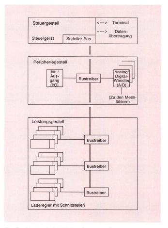
Fig. 5 Blockschaltbild des Steuergerätes
