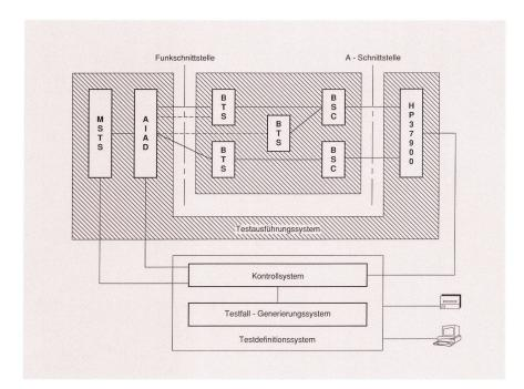
Fig. 3 Struktur des Konformitätstestsystems für GSM-Basisstationen
