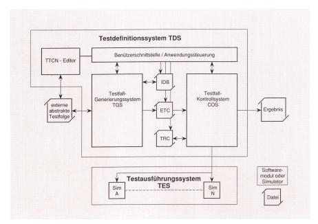
Fig. 1 Schematische Struktur eines TTCN-Testsystems
