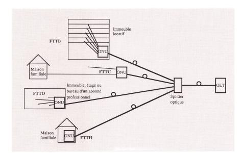
Fig. 6 Système de transmission basé sur un PON
