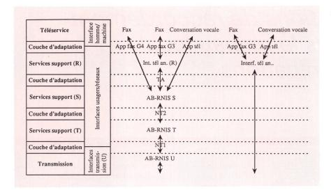
g. 1 Représentation des trois couches fonctionnelles principales dans le réseau d'accès (téléservices, services support et transmission)
