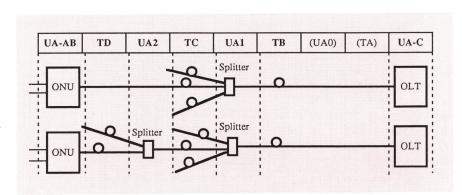
Fig. 14 Installation d'un PON FTTO/ FTT
