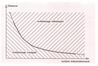
Fig. 10 Fonction n x d = p de subdivision du réseau d'accès en deux parties
