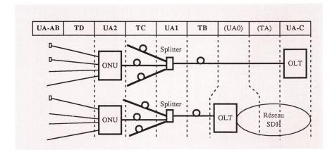
Fig. 13 Système basé sur un PON (FTTC, FTTB, FTTH ou FTTO) Il peut être utilisé avec ou sans SDH. Le principal inconvénient de son utilisation avec la SDH est l'installation de l'OLT à l'extérieur. Cela rend une intégration efficace des équipements SDH et des OLT dans l'UAO souhaitable
