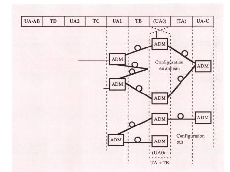
Fig. 11 Configuration SDH en anneau
