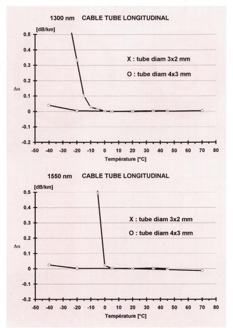
Fig. 9 Comportement thermique de rubans tubés quasi longitudinaux
