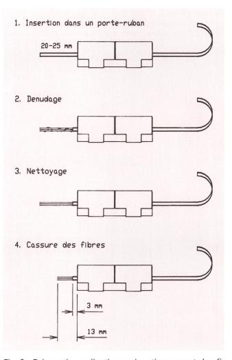
Fig. 2 Préparation collective au jonctionnement des fibres optiques d'un ruban Les étapes successives des manipulations sont schématisées
