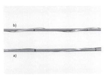
Fig. 6 Variantes d'assemblage d'un ruban autour d'un élément central cylindrique
