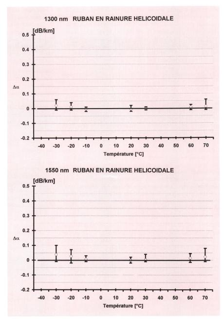
de -20 °C à +75 °C. Un câble prototype construit sur cette base (coupe *fig. 7b*) a été testé avec succès en température (fig. 9).
