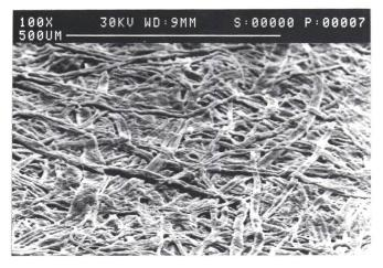
Fig. 1 Oberfläche eines ungestrichenen Papieres (Briefpapier) unter dem Rasterelektronen-Mikroskop (REM)
