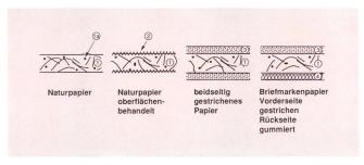
Fig. 4 Vereinfachter Querschnitt durch verschiedene, unbedruckte Papiere (Papierdicke = etwa 0.1 mm)
