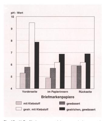
Fig. 12 pH-Profil eines ungestrichenen und eines gestrichenen Briefmarkenpapieres, vor und nach dem Wässern, d.h. mit und ohne Gummierung
