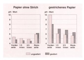
Fig. 11 pH-Profil eines ungestrichenen und eines gestrichenen Briefmarkenpapieres, vor und nach 24 Tagen beschleunigter Alterung bei 80°C und 65 % relativer Feuchtigkeit
