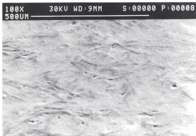
Fig. 2 Oberfläche eines gestrichenen Papiers (Zeitschriftenpapier) unter dem Rasterelektronen-Mikroskop
