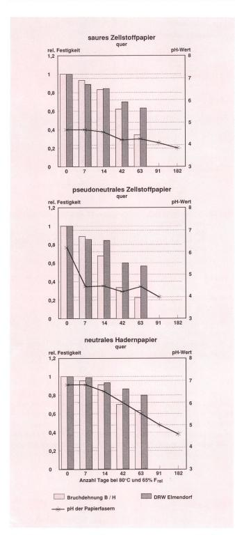
Fig. 13 Alterungsverlauf eines sauren, ungestrichenen Zellstoffpapieres, eines pseudoneutralen, ungestrichenen Zellstoffpapieres und eines neutralen, ungestrichenen Hadernpapieres/Vergleich von drei verschiedenen Messmethoden Festigkeiten vor der Alterung = 1
