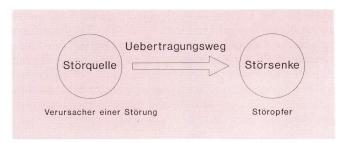
Fig. 1 Wirkmechanismus einer elektromagnetischen Störung
