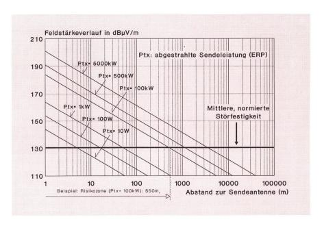
Fig. 5 Risikozone im Nahbereich von Sendeanlagen
