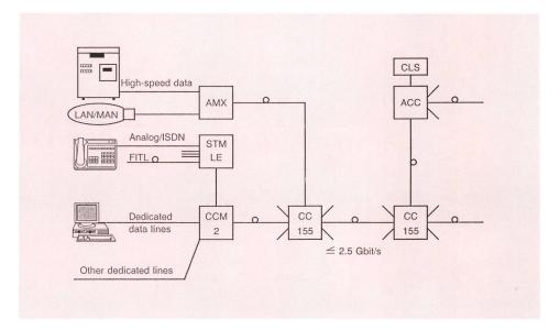
An Diensten werden semipermanente virtuelle Pfade und Kanäle in Punkt-zu-Punkt-Konfiguration angeboten. Die ATM-Zellen werden über das SDH-Netz in Containern vom Typ VC4 transportiert. Die Teilnehmer-Netz-Schnittstelle (UNI: User Network Interface) hat eine Bitrate von 155 MBit/s und beruht auf SDH in der physikalischen Schicht.
