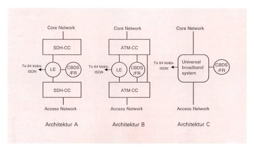
Fig. 5 Netzevolution: Phase 3, Architekturen
