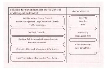
Fig. 1 Verkehrs- und Überlaststeuerung
