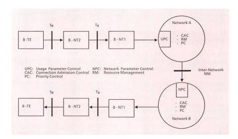
Fig. 2 Referenzkonfiguration für die Verkehrs- und Überlast- steuerung
