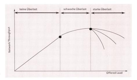
Fig. 3 Durchsatz bei Netzüberlast
