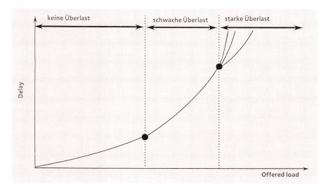
Fig. 4 Verzögerung bei Netzüberlast
