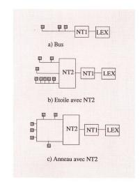
Fig. 1 Configurations supportées dans la terminaison d'abonné
