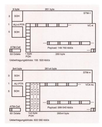
Fig. 3 Übertragung von ATM über SDH
