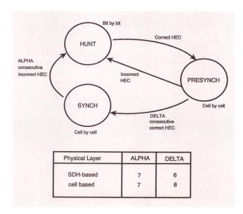
Fig. 2 Statusdiagramm der Zellenabgrenzung
