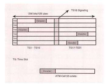
Fig. 5 Transport von ATM-Zellen in einem 2048-kbit/s-Rahmen
