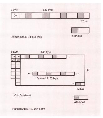
Fig. 6 Transport von ATM-Zellen in einem 34 368-kbit/sund 139 264-kbit/s-Rahmen
