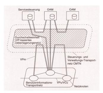
Fig. 7 VPCC-Überlagerungsnetz als Steuerungs- und Verwaltungstransportnetz
