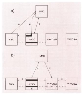
Fig. 5 Einrichten von «On-Demand»- und semipermanenten Verbindungen
