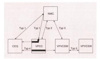
Fig. 4 Kommunikationstypen im VP-/VC-Netz
