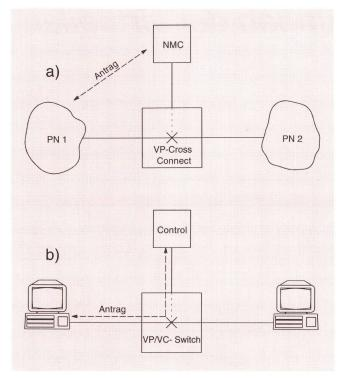
Fig. 2 Durchschalteeinheit (Cross-Connect) und Vermittlung (Switch)
