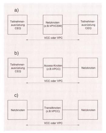
Fig. 3 Anwendungen von VP- und VC-Verbindungen
