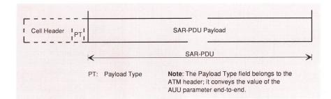
Fig. 6 SAR-PDU-Format für den AAL-Typ 5
