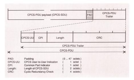
Fig. 7 CPCS-PDU-Format für den AAL-Typ 5
