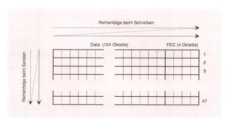
Fig. 2 Verschachtelungsschema für Fehlerkorrektur (Sender)
