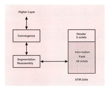
Fig. 2 ATM-Anpassungsschicht (ATM Adaptation Layer)
