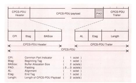
Fig. 4 CPCS-PDU-Format für den AAL-Typ 3/4
