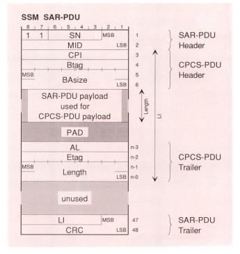
Fig. 5 Ein-Zellen-CPCS-PDU
