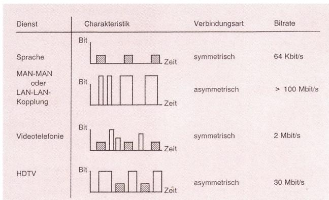
Fig. 1 Charakteristiken einiger Dienste – Caractéristiques de quelques services
