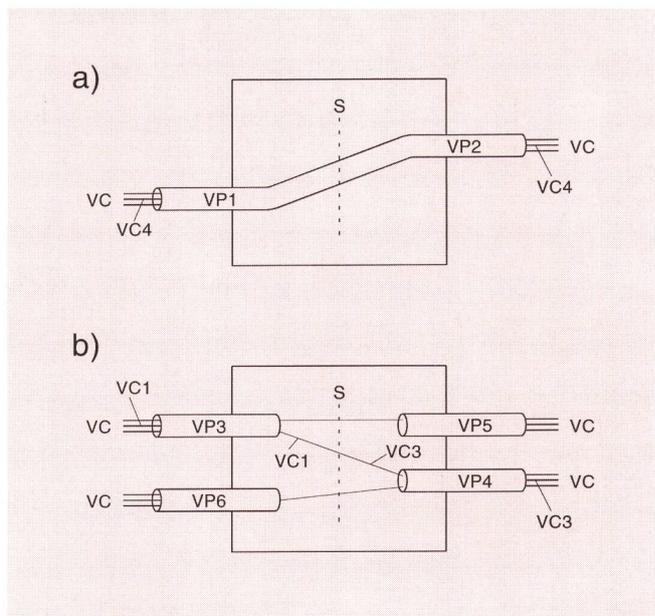
Fig. 5 VP und VC-Schaltung – Commutation VP et VC
