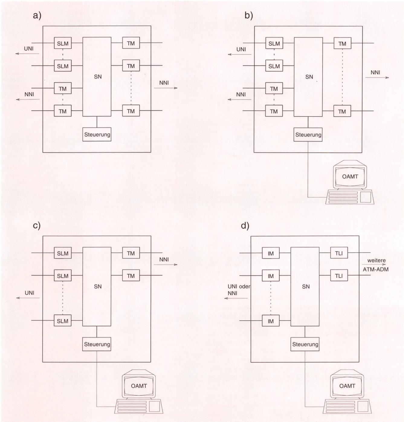
Fig. 9 ATM-Netzelemente – Principaux éléments du réseau
