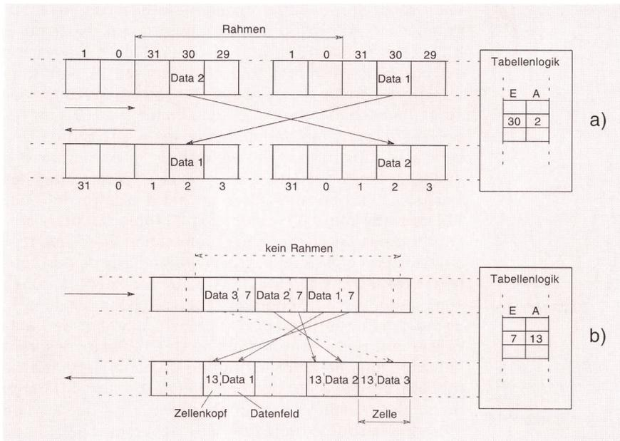
Fig. 2 Vergleich ATM-STM – Comparaison MTA/MTS
