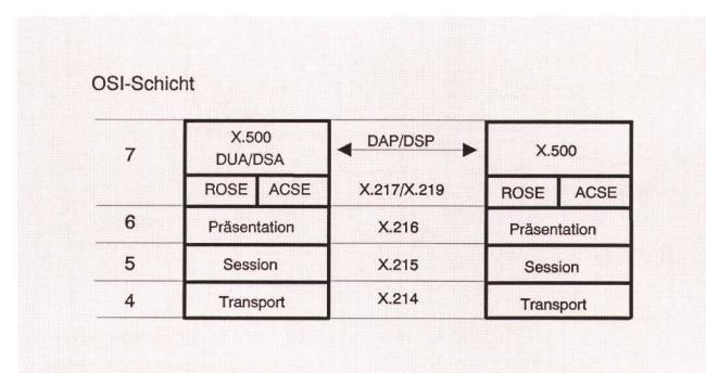
Fig. 3 Einbettung in das OSI-Referenzmodell – Incorporation au modèle de référence OSI
