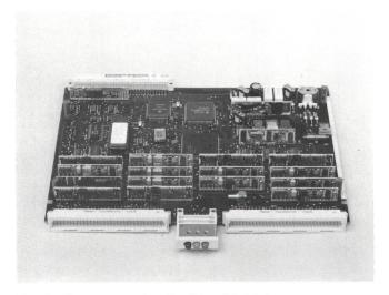
Fig. 4 Baugruppe des flexiblen Multiplexers
