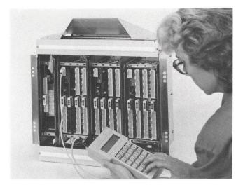
Fig. 5 Baugruppenträger und Handbediengerät
