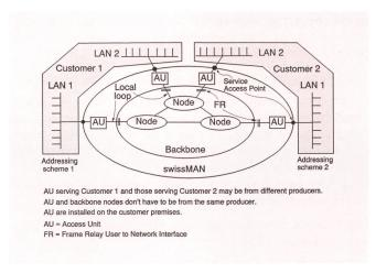
Fig. 3 Position des interfaces Frame Relay et des points d'accès au service
