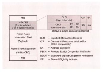
Fig. 8 Format d'une trame Frame Relay
