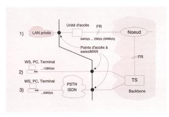
Fig. 2 Les trois types de raccordement à swissMAN
