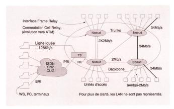
Fig. 4 Architecture de la solution «Cell Relay»
