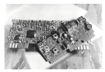
Fig. 5 Modul mit der Chip-on-board-Technologie inklusive FM-Front-End
