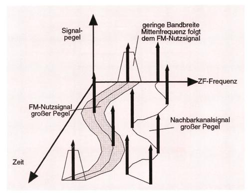
Fig. 3 Verhalten bei starken Nachbarkanalstörungen
