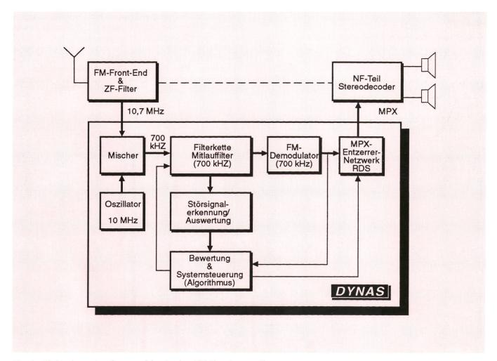
Fig. 1 Einbindung des Systemchips in den FM-Empfangsteil
