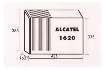
Fig. 3 Gehäuseabmessungen
