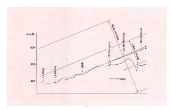
Fig. 3 Coupe transversale Mt-Pèlerin – Lausanne Echelle ~ 1:100 000/1:10 000 Représentation décuplée
