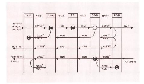
Aufbau einer Swissnet-Verbindung
