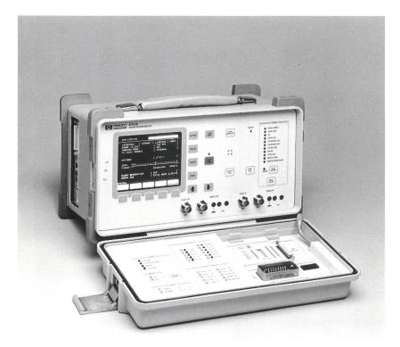
Erlaubt Bitfehlerratentest (BER-Test) an Kommunikationssystemen mit Datenraten bis zu 8 MBit/s, während oder ausserhalb des Betriebes. Die Ergebnisse von Langzeittests werden in Form von übersichtlichen Grafiken dargestellt.
