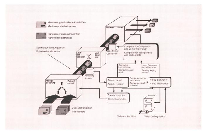
Fig. 10 Integriertes Lese- und Videocodiersystem (ILV)
