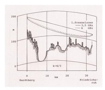
Fig. 1 Profil einer Richtfunkstrecke
