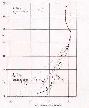
Dämpfungsverlauf für  $h_s = 54.5 \, \text{m}$ Streckenprofil entsprechend Figur 5
