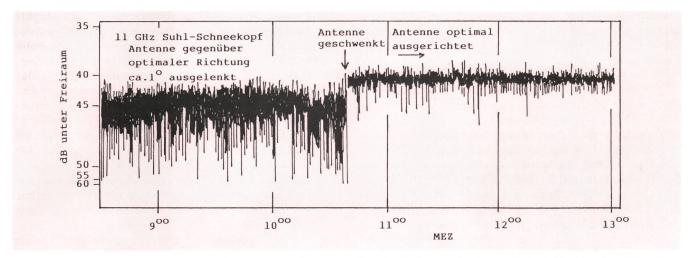
Fig. 10 Kurzperiodische Feldstärkeschwankungen bei optimaler Ausrichtung der Antennen und bei horizontaler Auslenkung einer Antenne um 1°, 11-GHz-Strecke, d = 8,3 km, Beugung an Bergkante mit dichtem Fichtenwald, Zusatzdämpfung 42 dB
