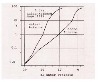
Fig. 9 Schwundwahrscheinlichkeit an einer 2-GHz-Richtfunkstrecke
