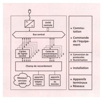
Fig. 8 Architecture du système – Architettura del sistema
