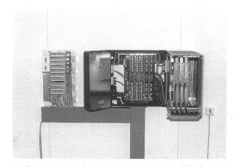
Fig. 7 La conception en trois parties de l'équipement est bien visible lorsque le boîtier est ouvert – Quando il contenitore è aperto la struttura composta di tre parti è ben visibile
