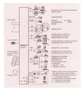
Fig. 4 Conception de raccordement de l'installation Ascotel bcs 64 RNIS – Possibilità di allacciamento dell'impianto Ascotel bcs 64 versione ISDN
