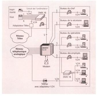
Fig. 5 Services de téléphonie et de données intégrés, fonctionnant à l'aide du système Ascotel bcs 64 RNIS – Servizi integrati di telefonia e dati con l'Ascotel bcs 64 versione ISDN
