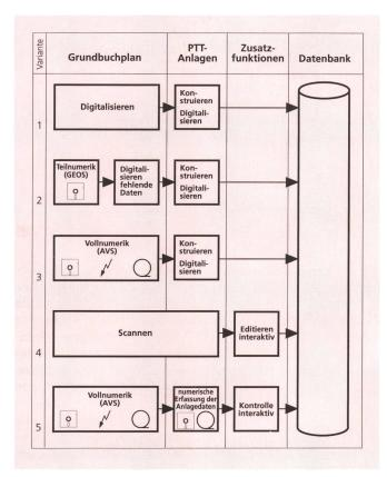
Fig. 2 Datenübernahme – Varianten für Situationsplan AVS Amtliche Vermessungsschnittstelle
