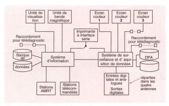
Fig. 1 Configuration du système Esmos
