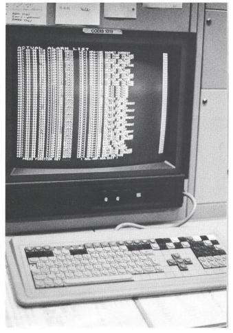
Fig. 5 Console d'opérateur du système de surveillance et d'acquisition des données
