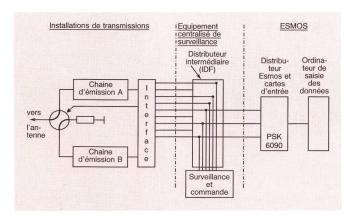
Fig. 3 Connection des installations à Esmos PSK 6090 Cartes d'entrée
