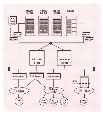
Fig. 3 Systemkonfiguration des Zentralrechners
