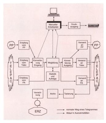
Fig. 6 Anwendungskomponenten im Zentralrechner
