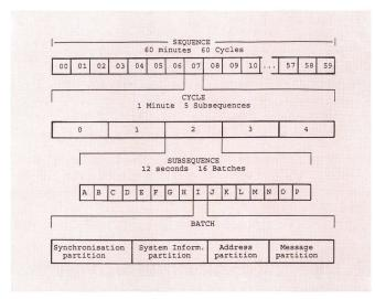
Fig. 3 Struktur des Übertragungsprotokolls auf einem Kanal
