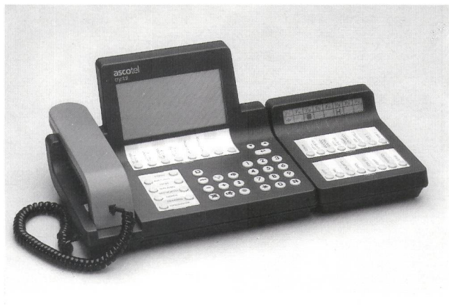
Fig. 7 Digitales Endgerät Ascotel Crystal Angeschlossen ist ein Optionsmodul OMC 16
