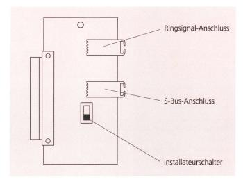
Fig. 6 Klemmenanschlussplatte KLA-ZES
