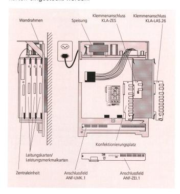
Fig. 4 Mechanische Konstruktion
