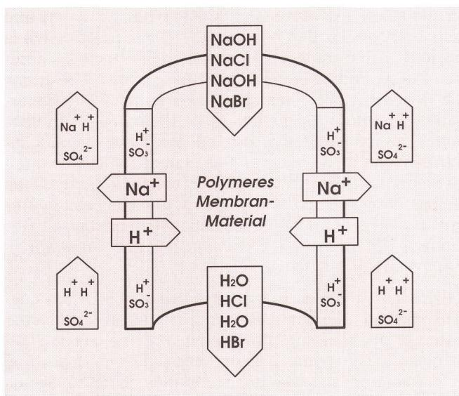
**Fig. 8 Dionex-Mikromembransuppressor – Supressor à micromembranes Dionex**
