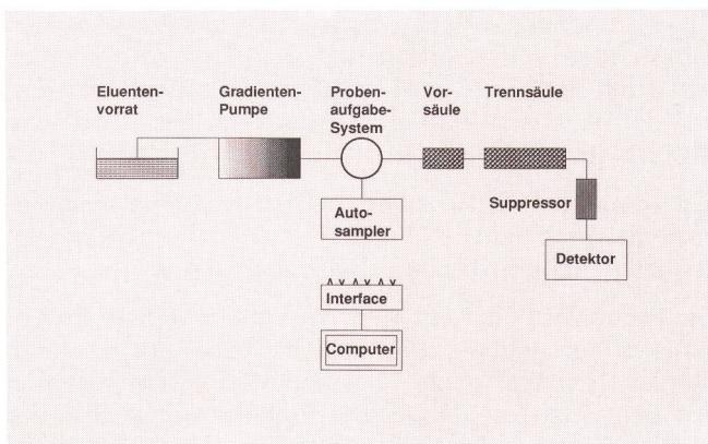
**Fig. 9 Aufbauschema des Dionex-HPLC-Systems – Schéma d'installation du système HPLC Dionex**
