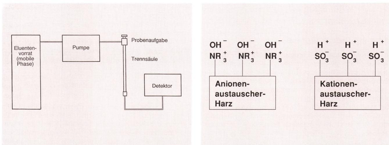
*Fig. 4 Aufbau einer HPLC-Apparatur – Constitution d'un appareillage HPLC*
