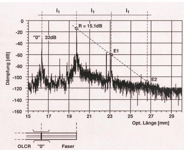
Fig. 10 Transition fibre-fibre (connecteur optique) – Passaggio fibra-fibra (conduttore ottico)
