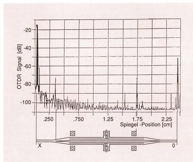
Fig. 5 Réflexion d'un interféromètre du type *Mach-Zehnder* – Riflessioni misurate con un interferometro di *Mach-Zehnder*
