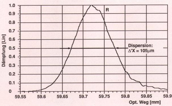
*Fig. 14 Dispersion dans un guide d'ondes  $\text{LiNbO}_3$  – Dispersione nella guida d'onda  $\text{LiNbO}_3$*
