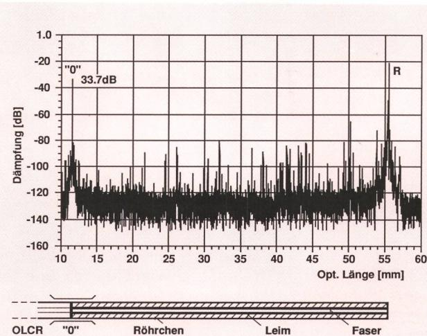
**Fig. 12 Fibre enrobée – Fibra in tubetto**
