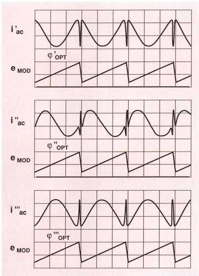
Fig. 7 Modulation de phase en dents de scie – Modulazione di fase a denti di sega
