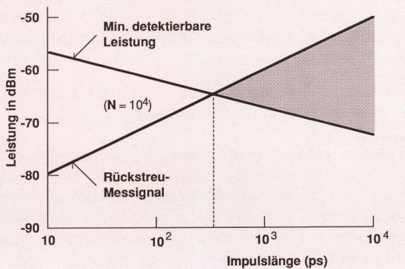
**Fig. 3** Signal de mesure rétrodiffusé et puissance minimale détectable dans une fibre monomode en cas de détection directe – Segnale di misura retrodiffuso e potenza minima rivelabile in una fibra monomodale con rivelazione diretta
