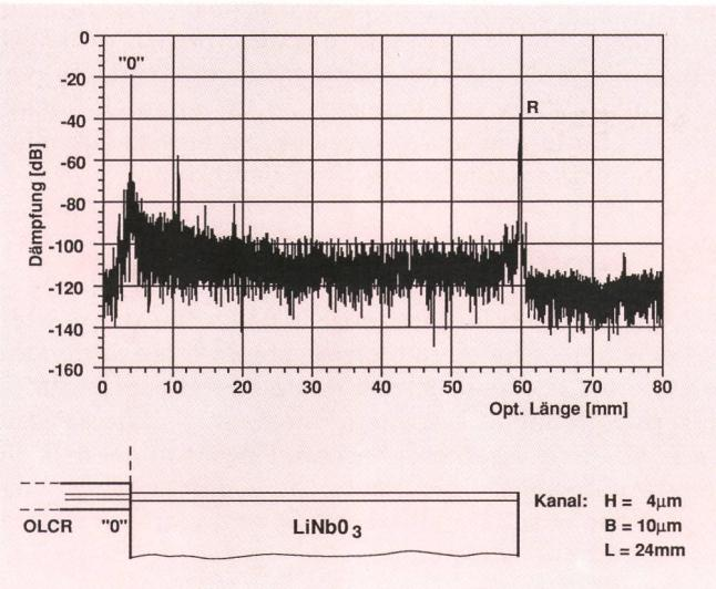
*Fig. 13 Réflexions dans un guide d'ondes  $\text{LiNbO}_3$  – Riflessioni nella guida d'onda  $\text{LiNbO}_3$*
