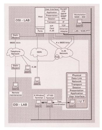
Fig. 10 Aufbau von OSI-LAB
