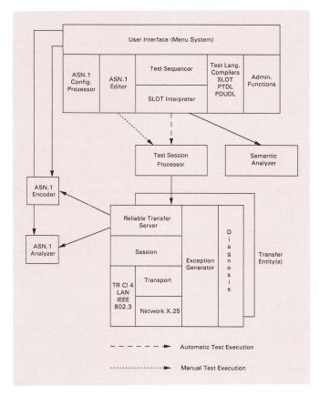
Fig. 9 Systemkomponenten von Ositest/400
