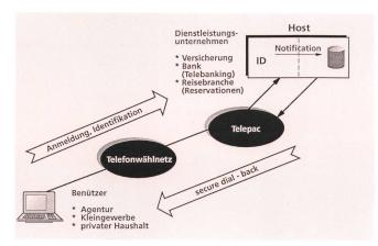
Fig. 5 Sicherheitslösung mit X.32-Anwahl
