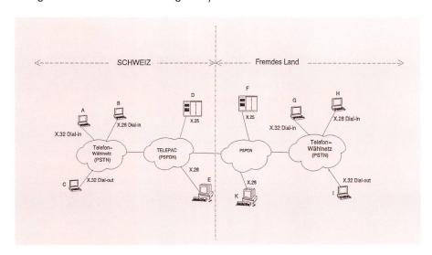
Fig. 3 Konfiguration für Verkehr mit dem Ausland
