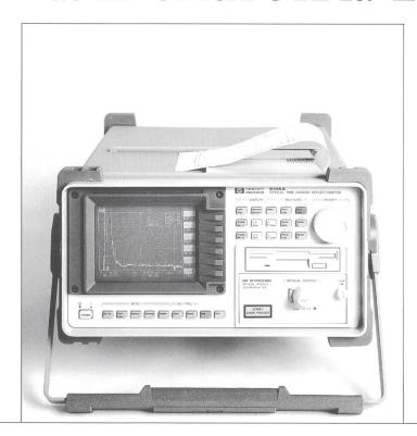
Das HP 8146A all-haul OTDR erlaubt die automatische Charakterisierung von faseroptischen Kurz- und Langstreckenverbindungen innerhalb von weniger als 7 Sekunden.
